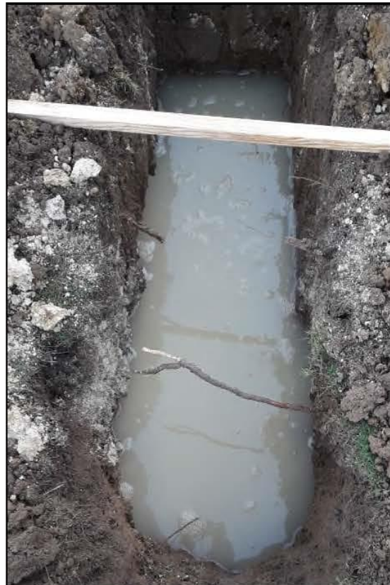
Photographie de l'essai de perméabilité EPM15 (Absence de descente du niveau d'eau)
